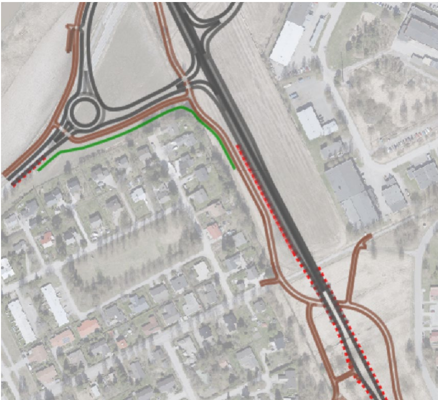
Meluntorjuntarakenteita: meluseinä vihreällä viivalla ja melukaide punaisella katkoviivalla. Ilmakuva © Salon kaupunki.
